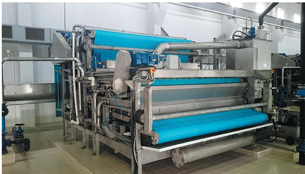
Рис. 1. Ленточный фильтр-пресс
